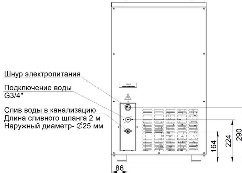
Рис. 4 Схема подключения льдогенератора
